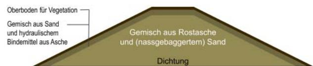
Abb. 4.10. Empfohlener Regelquerschnitt für einen neuen Deich unter Verwendung von Aschen
