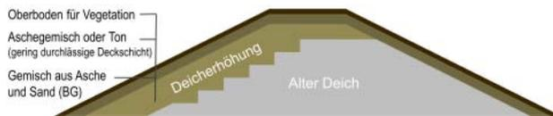
Abb. 4.13. Empfohlener Regelquerschnitt für eine Deicherhöhung unter Verwendung von Aschen
