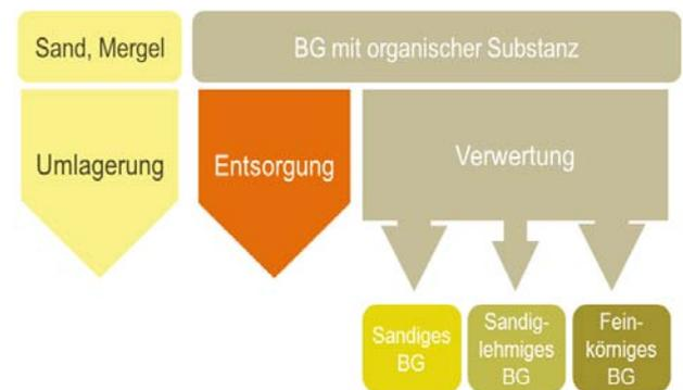
Abb. 2.2. Umlagern, verwerten und entsorgen von Baggergut
