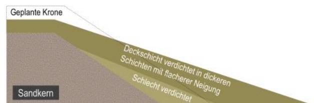
Abb. 5.6. Mögliches Problem bei der Installation von Material in einer geringeren Neigung für spätere Profilierung der Böschung
