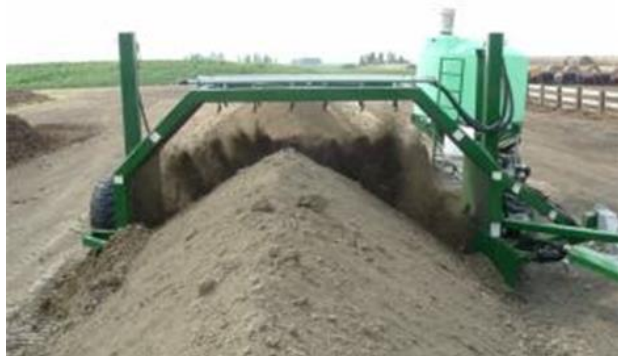
Rys. 5.2. Homogenizacja DM w pryzmie [15]
