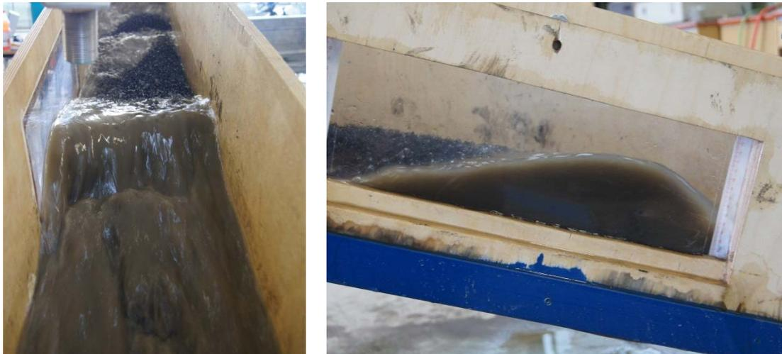
Abbildung 7.9: Versagen der Erosionsschutzmatte in Versuch 2 Material 2
