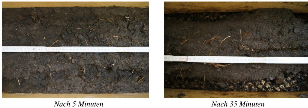
Abbildung 7.2: Entwicklung der Erosion in Versuch 1 von Material 1
