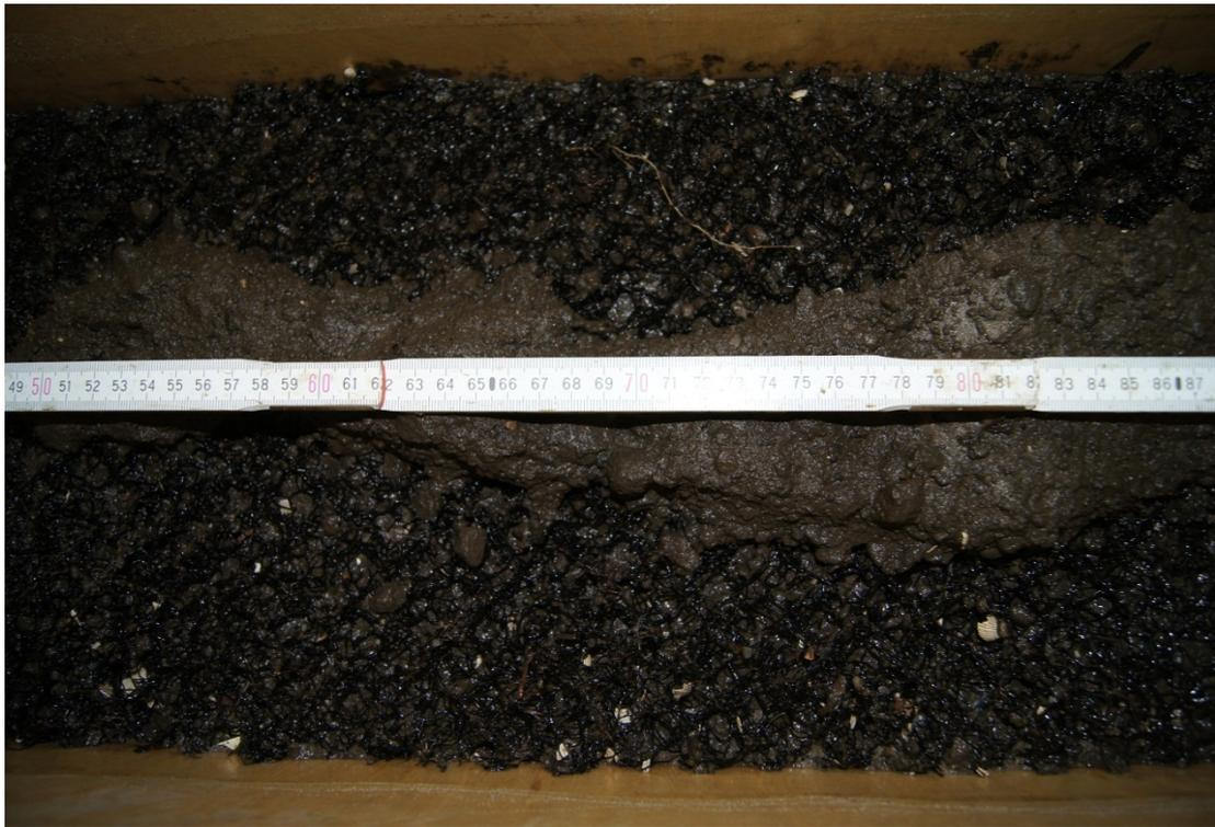
Abbildung 7.8: Fast vollständige Erosion der Bodenschicht oberhalb der Erosionsschutzmatte in Versuch 2 Material 2
